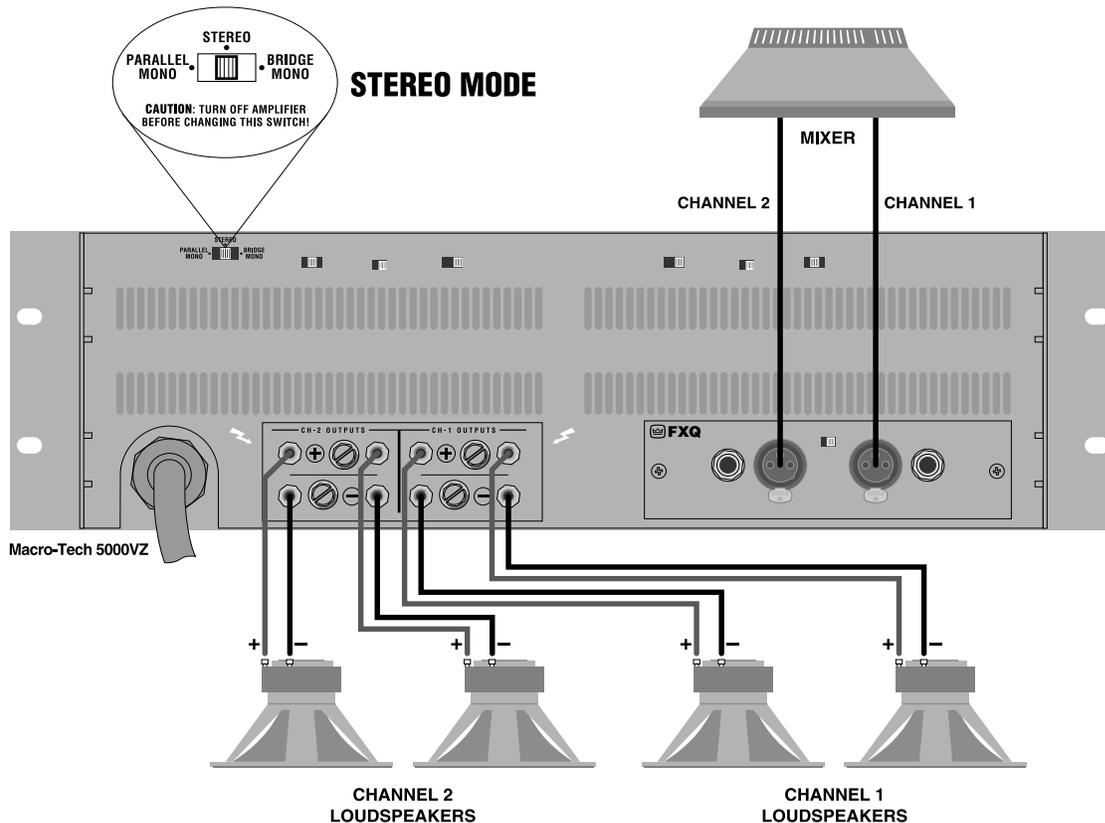
Fig. 3.4 Stereo Wiring
