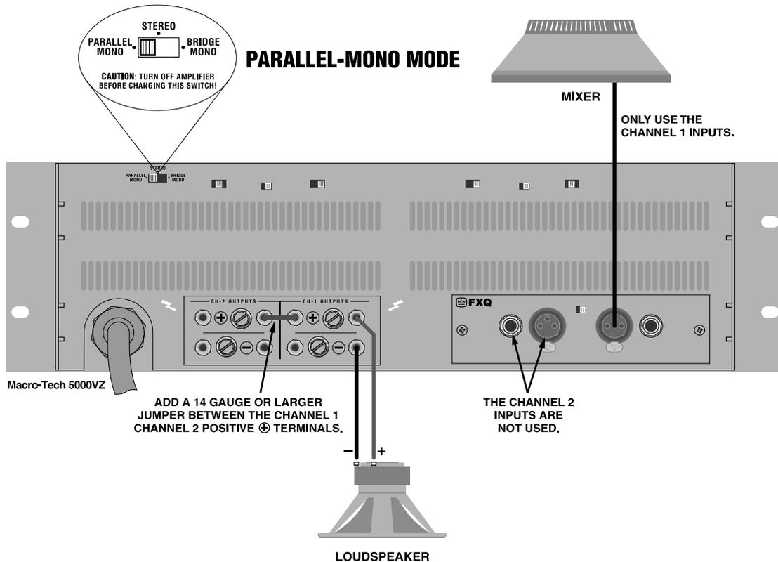
Fig. 3.6 Parallel-Mono Wiring
